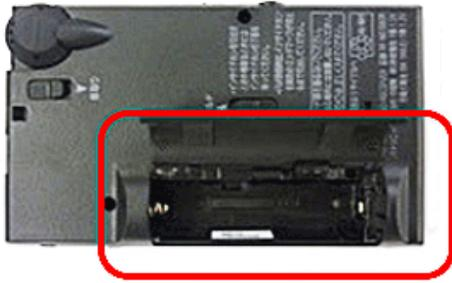
製品本体の電池蓋を開け、電池が入っていない状態で、製造番号が記載されているラベルの横をご確認ください。緑のマークのないものが交換対象品です。
