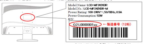
(LCD-MF242XBR の例 シール部分拡大)
