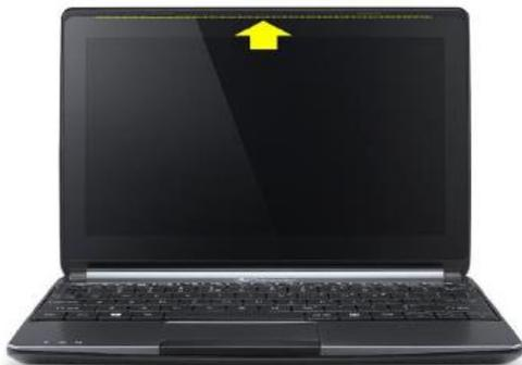
タッチパネル液晶上部のフレーム部分を押し、タッチパネル液晶ユニットと天板フレームの間に隙間ができる可能性があります。
